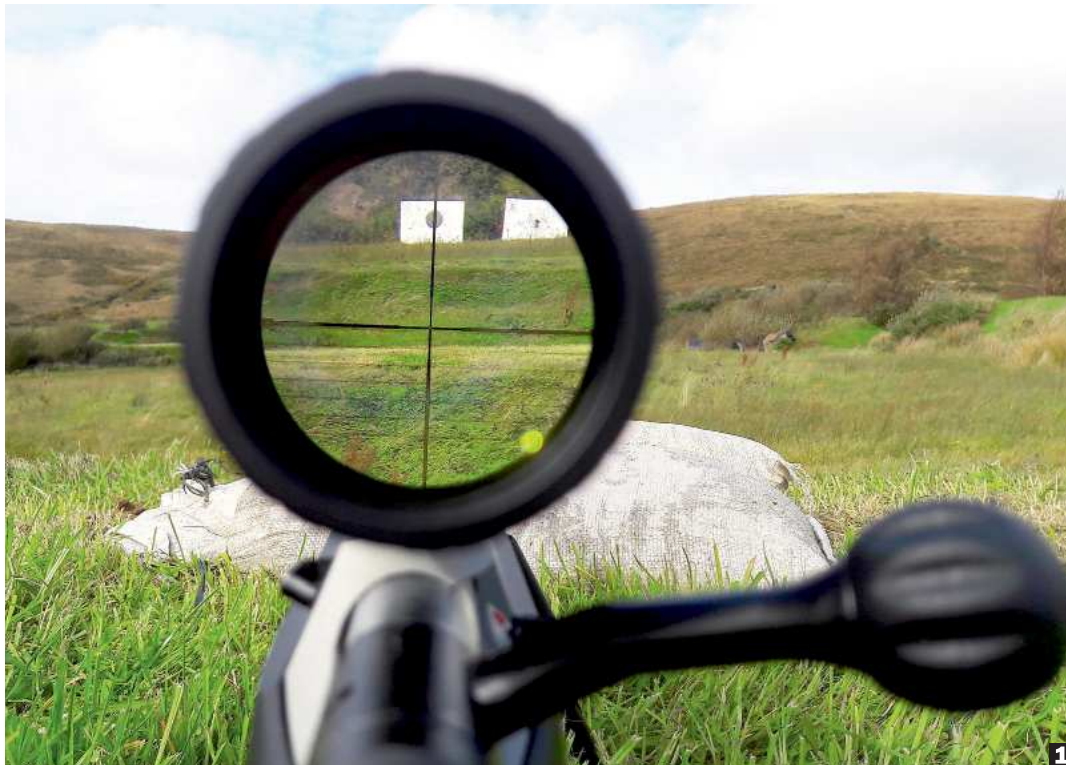
1 Il reticolo del cannocchiale Sierra 3 Bdx 6,5-20x52.
